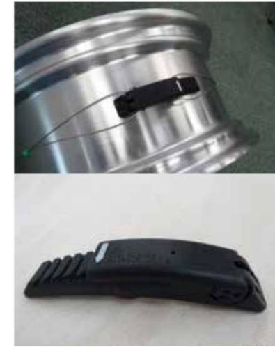
ホイールに装着したTPMSセンサー (Tire Pressure Monitoring System)
